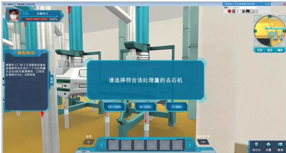
(4) 右键点击门，在弹出的菜单中选择去麦间三层，找到滚筒精选机，点击精选机，弹出设备选型题目，选择 12t/h，完成精选机的设备选型题目。
