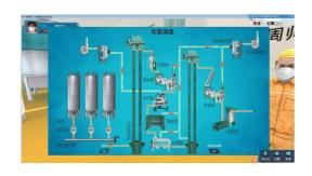
(1) 去车间五层,找到毛麦清理第一道振动筛,点击振动筛的大杂出口弹出检测 图片。根据图片判断检测是否合格。如不合格对振动筛进行调节,点击振动 电机的上部,通过调大或调小振幅来调节振动筛。
