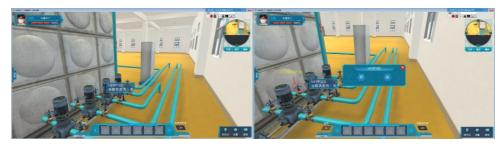
(6) 找到泵后阀 V02P103, 查看阀门状态。如果阀门是关闭状态,则点击打开阀门 V02P103。
