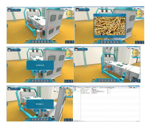
(2) 去车间四层找到毛麦清理第一道去石机,点击去石机取样孔弹出检测图片,观察图片,判断是否合格。如不合格,调节去石机风门。点击风门条按钮,将风压调节到500-880Pa。
