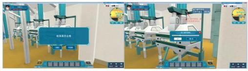
(3) 去车间三层找到精选机,找到精选机物料管道的检测口进行取样,对取得样品进行检测分析,判断是否合格。如不合格,去调节精选机下滚筒的收集槽调节手轮。点击下滚筒收集槽调节手轮,调节收集槽角度到10-30°之间。
