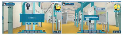
(5) 去车间7层,检查着水系统运行状态,查看阀门状态。找到泵前阀 V01P103,如果阀门是关闭状态,则点击打开阀门。
